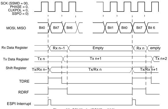
Figure 28. SPI Mode (SSMD = 000)
